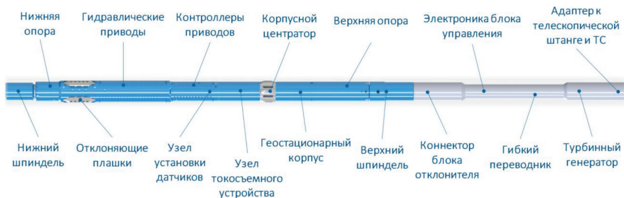
Рис. 6. Роторно-управляемая система РУС-124Т разработки и производства ООО НПП «БУРИНТЕХ»
