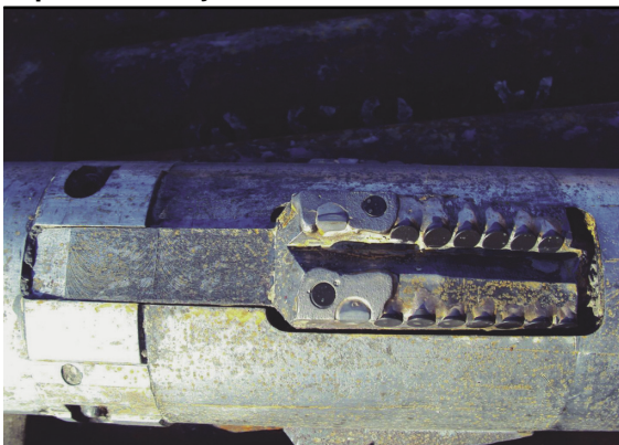
Рис. 4. Раздвижной расширитель для скважин с высокими значениями зенитного угла, в том числе горизонтальных участков
