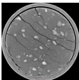
Разрушенный керн при спуске трубы с прогибом
