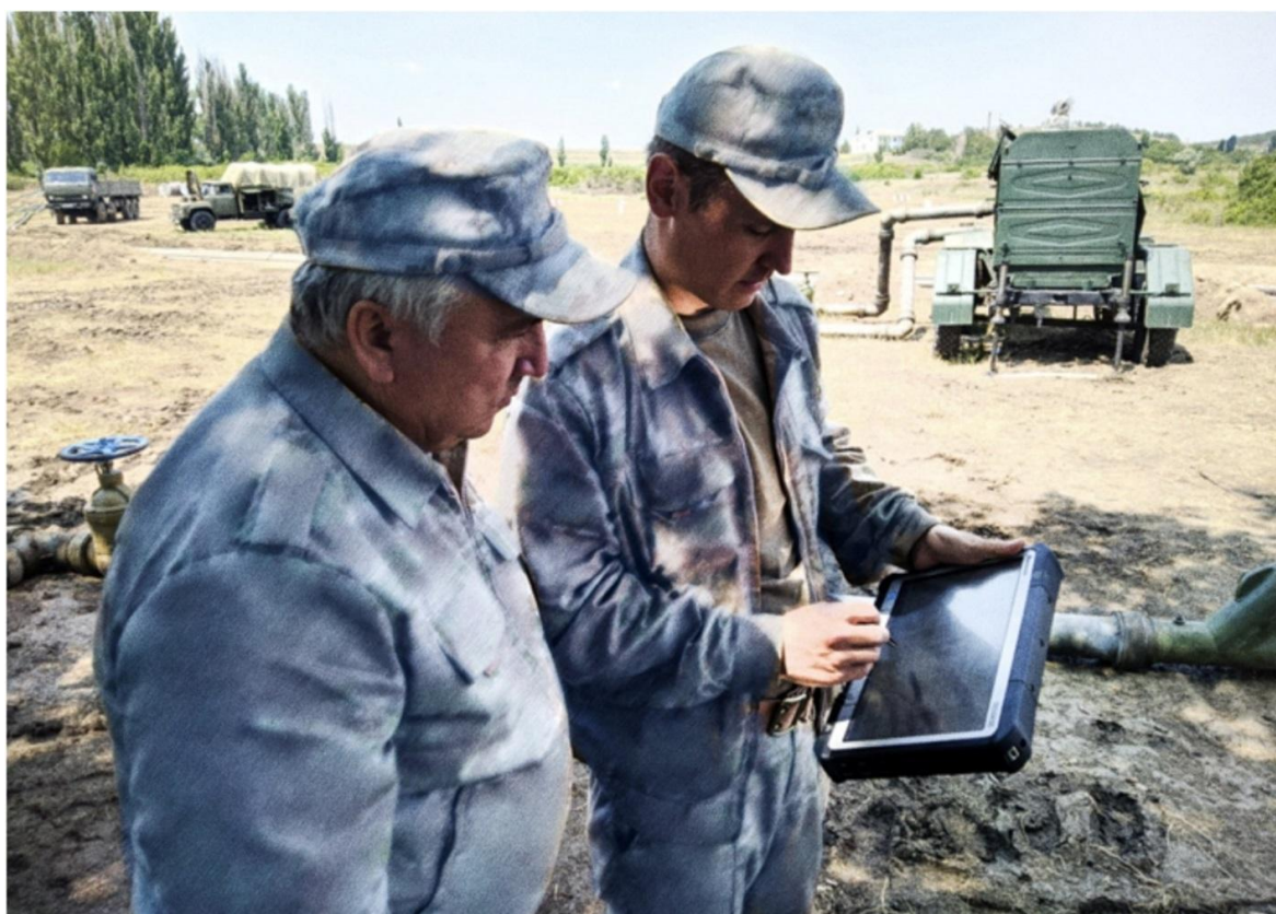
Рисунок 3. Использование МДЦ 14Ц8004 для определения координат положения и высотных отметок трассы трубопровода на направлении «Тайганский гидроузел - Симферопольское водохранилище»
