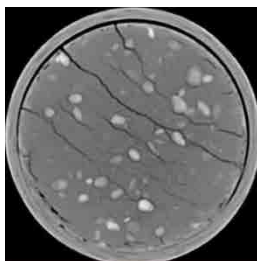
Разрушенный керн при спуске трубы с прогибом
