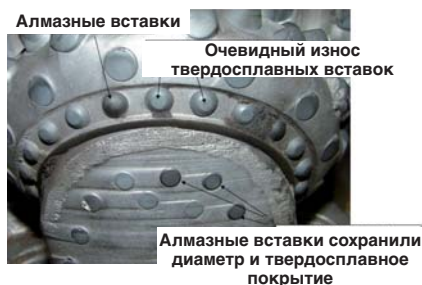
Опции алмазной защиты 25% алмазов на калибрующей части
