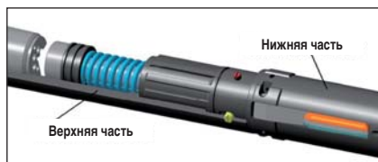
Рис. 7. Принцип системы аварийного возврата лопастей
